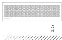
В том случае, если вход, над которым устанавливается оборудование, шире длины воздушной завесы, рекомендуется устанавливать два или несколько устройств вместе. В этом случае следует оставлять щель в 10-40 мм между оборудованием.
